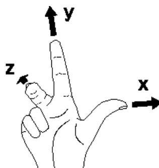
Règle de la main droite : la direction des doigts qui se ferment dans la main indique le sens positif de l'angle de rotation.
