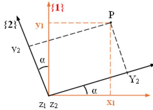
Cette matrice est appelée matrice de rotation, matrice de passage ou matrice de changement de base, Il est possible de définir d'autres rotations rapport aux axes x et y comme suit:
